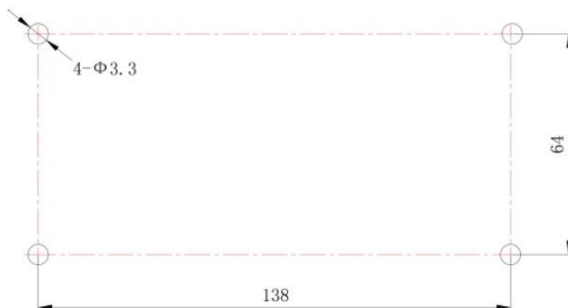
Rys. 9. Rozstaw otworów montażowych
